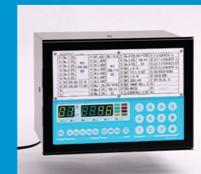
■ 船用機関室監視用多機能モニター MAC-6000 / 3000 MPHR-6000 / 3000 最大60点計測。K熱電対、Pt100、4-20mAに対応。警報接点出力最大16点(オプションで60点)。
