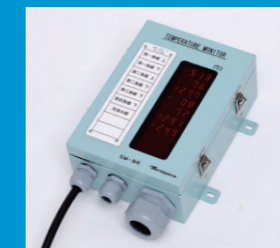
■ 一括表示モニター SM-9HF / SM-9R / GM-18 LED一括表示式モニター。9および18点計測仕様から選択できます。オプションでRS485出力追加と子機装着で離れた場所で温度表示が可能です。
