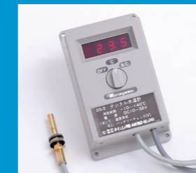
■ 小型漁船用デジタル水温計 DS-2 / DS-2N 半導体センサーを船底金具に取り付け水温を表示。船底金具はFRP船・アルミ船・銅船用があります。DS-2NはNMEA-0183出力機能付。
