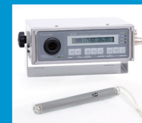
■ 小型水深水温計 SBT-500 / SBT-500SR-II / SBT-500用タグ 漁船の延縄にタグを漁の間装着し、引き上げたタグをポット(データ読取器充電器)に挿入しデータを取り込み。最大水深500mまで計測が可能です。
