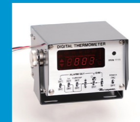
■ 潮目警報付デジタル水温計 DSN-2011 / DSN-2111 分解能0.01℃。潮目警報機能も搭載。水温データをNMEA-0183出力で航海計器へ出力可能です。パネル埋込式専用当板もあります。
